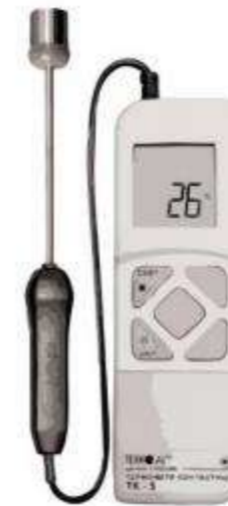
Поверхность ЖКТМ нельзя мерить контактными приборами
