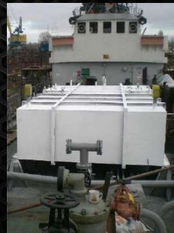
Изоляция рубки и технологических емкостей для хранения нефтепродуктов на речной барже
